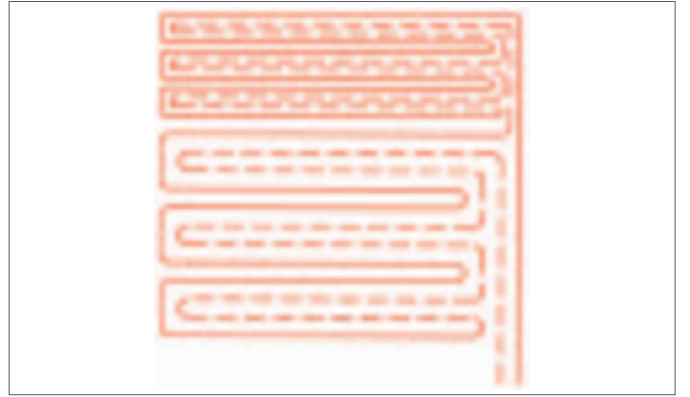
Şekil 3.10 Ön fazlı kenar bölgesi Çift - U modülasyon
