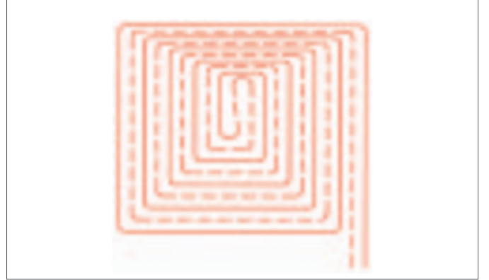
Şekil 3.5 Sıkıştırılmış entegre kenar bölgesi salyangoz modülasyon
