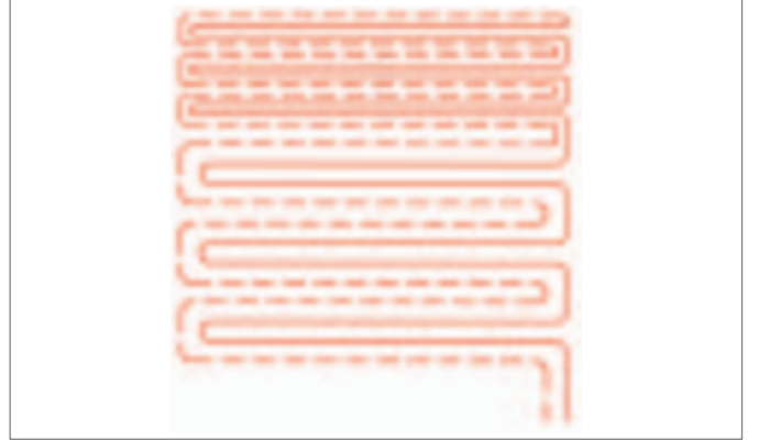
Şekil 3.9 Sıkıştırılmış entegre kenar bölgesi Çift - U modülasyon
