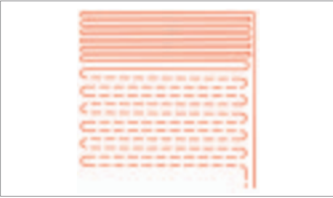
Şekil 3.8 Sıkıştırılmış kenar bölgesi Tek - U modülasyon
