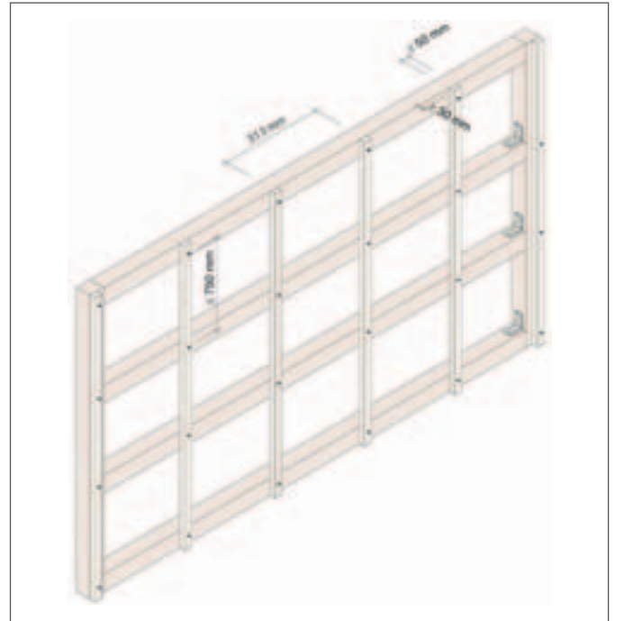
Şekil 4-32 Ahşap çerçeve yapısında alt konstrüksiyon örneği
